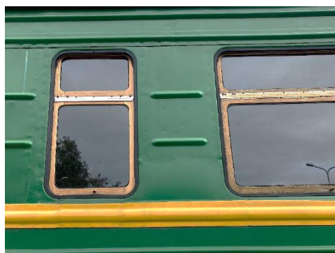
Pirms un pēc koka logu restaurācijas – vecās lakas noņemšana, pelējuma apstrāde, lakošana, 2021. gada augusts. Foto A.Pudāne
